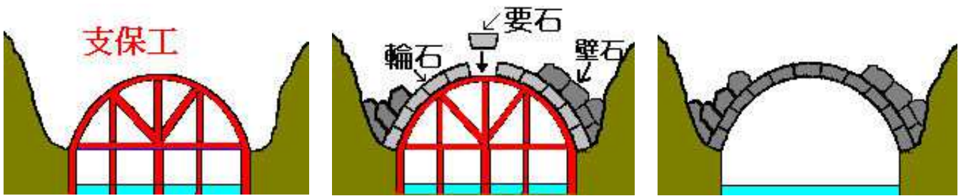
支保工を組み立てる
